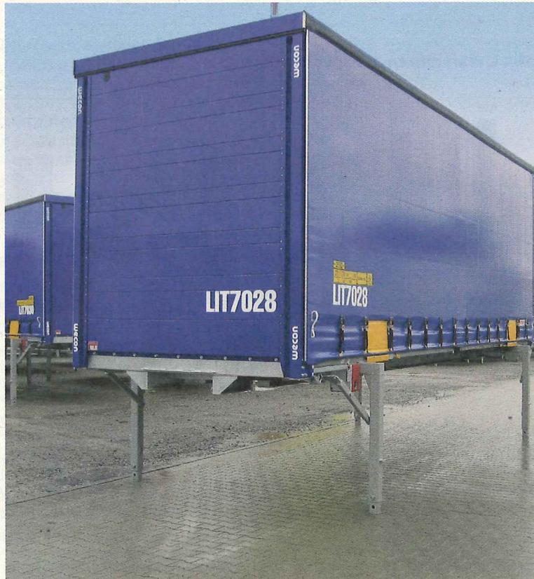
Made by Wecon: Schwerlast-Wechselbrücke mit Mobiler-Technik.
