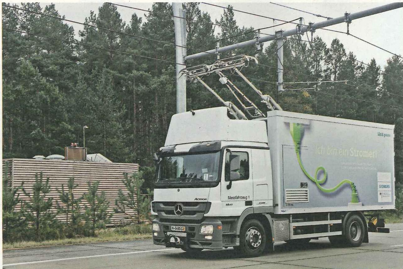
Nutzfahrzeug an der Stromleitung: Auf einer Teststrecke bei Berlin sind Lkw mit einem Siemens-System schon auf Probefahrt.
