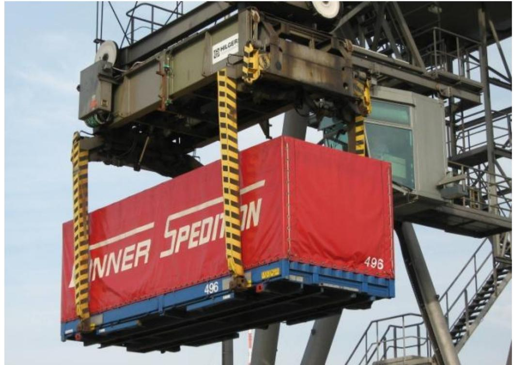
Kräne mit Greifzangen (Wechselbehälter mit Greifzonen und Eckbeschlägen unten)
