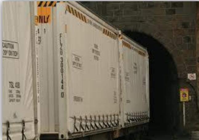
Insbesondere Tunnel beschränken das Lichtraumprofil. KV überschreitet das normale Lademaß der Bahnen.
