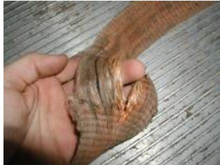
*Figura 36: Cinta seriamente danificada? Deite-a no caixote do lixo!*
