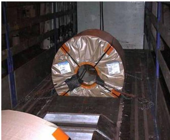
**Não são permitidos espaços vazios entre a frente da bobina e a protecção; as protecções devem estar colocadas de modo a que a bobina não possa mover-se para a frente.**
