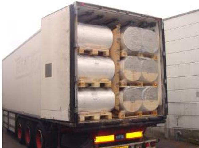
*Figura 18: Material de enchimento entre as camadas de carga*
