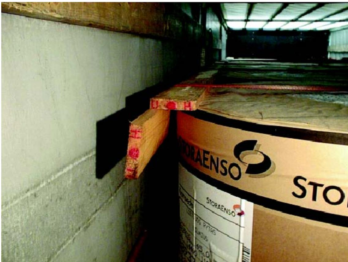
*Figura 53: Viga de bordadura feita de tábuas de madeira*
