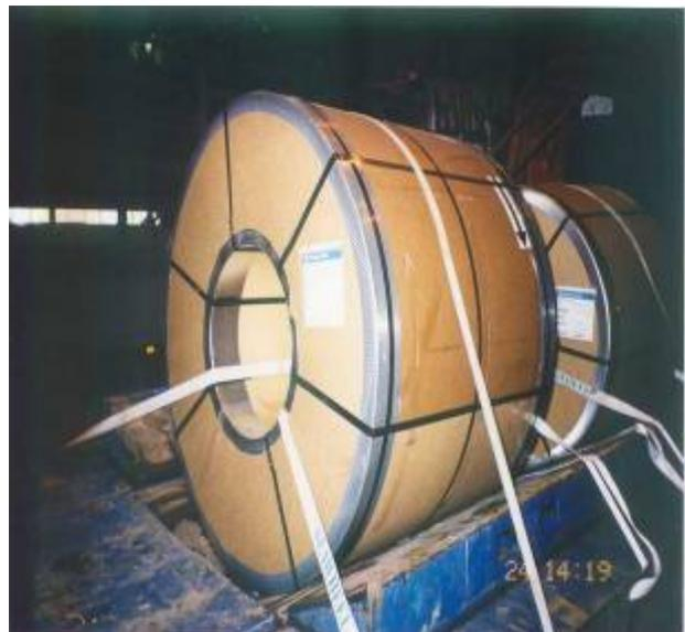
*12 Cintas através e à volta da bobina*
