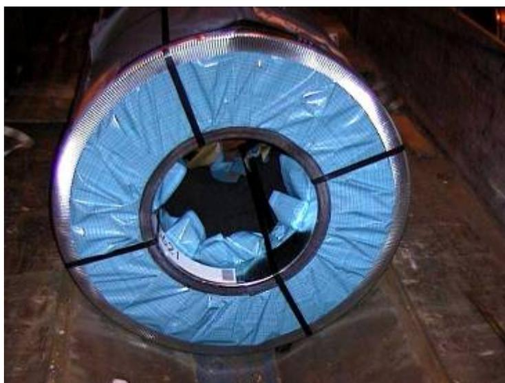
**A bobina deve assentar nos declives da calha. A distância entre a bobina e o fundo da calha deve ser, no mínimo, de 20 mm.**
