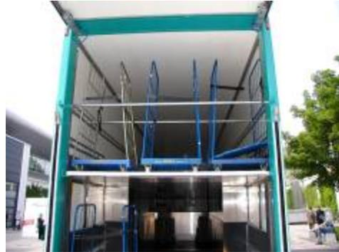
*Figura 64: Palete com rodas com suportes laterais e barras para grampos*
