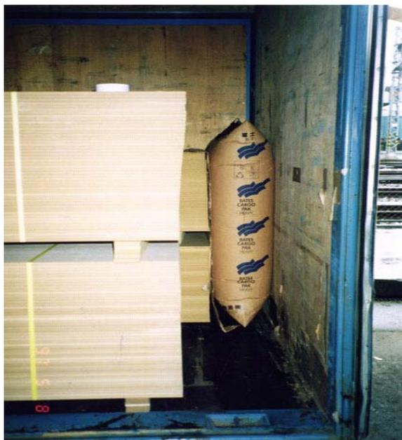
*Figura 19: Almofadas de ar num semi-reboque*
