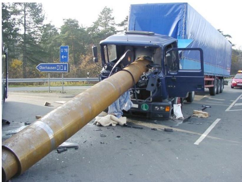
*Figura 1: Durante uma travagem de emergência, os tubos de aço mal acondicionados atravessaram o painel de protecção e a cabina do condutor.*
