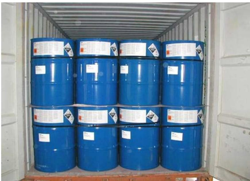
Tambores de aço, dispostos em pilhas duplas e acondicionados em bloco, fixados com cintas tensionáveis presas à estrutura do contentor.
