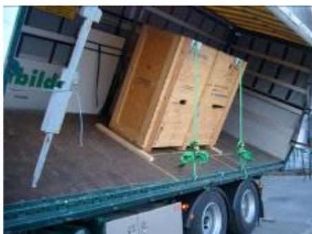
Ensaio de eficácia do equipamento de fixação de um recuperador de calor para acelerações frontais e laterais.
