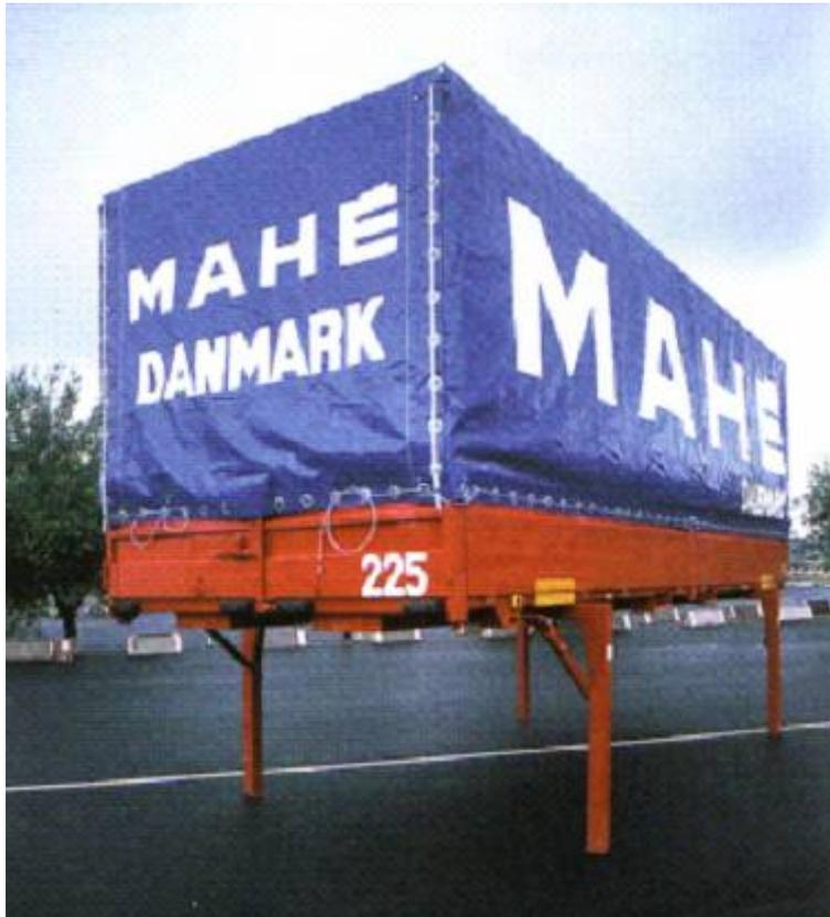
*Figura 16: Caixa móvel assente sobre pés de fixação (patolas)*
