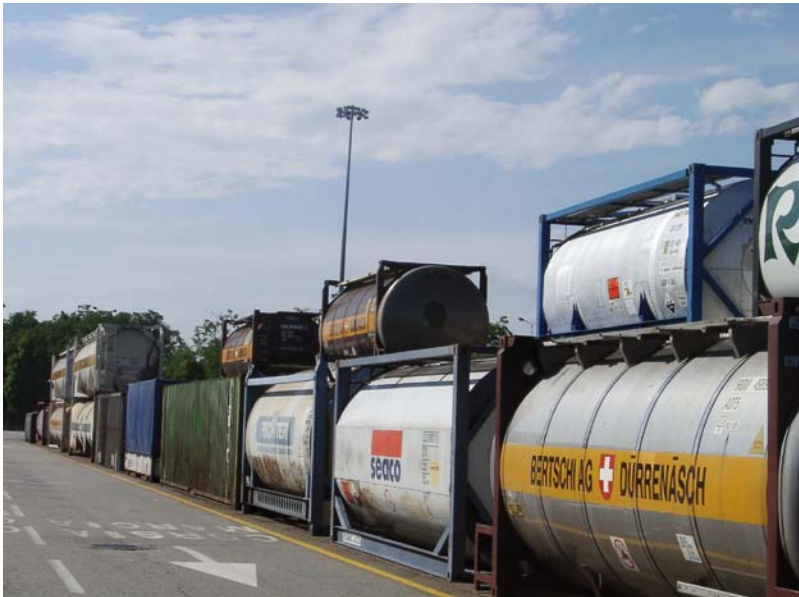
Tank-Container im Stapel
