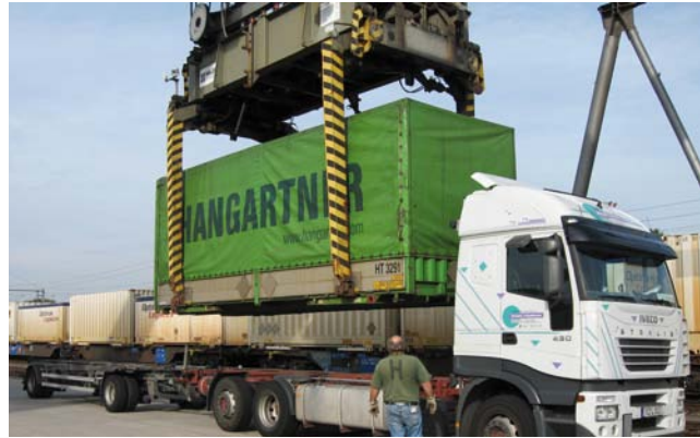
Wechselbehälter im Greifzangengeschirr
