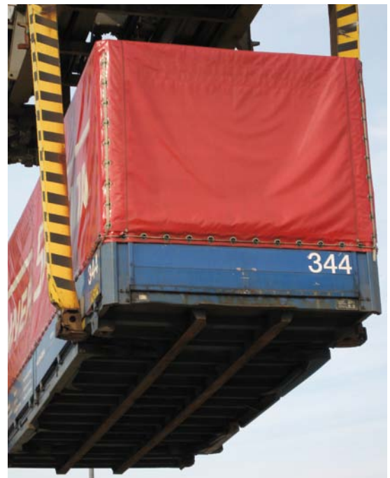
Wechselbehälter am Kran
