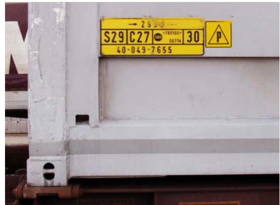
Markierung von Europäischen Ladeeinheiten
