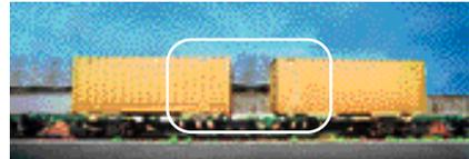
transport de caisses mobiles et des conteneurs et respecte les caractéristiques géométriques des wagons de type standard classés dans les fiches UIC. Il permet, grâce à son bogie Y25 de 22,5 tonnes maximum de charge par essieu et à son châssis plus léger, d'avoir une charge utile maximale de 72 tonnes sur des lignes de catégorie "D" (de 100km/h) et de 64 tonnes sur des lignes de catégorie "C" (de 120km/h).
