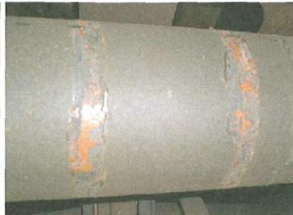
Fallen bei der Sichtprüfung durch (von oben links): Rillen, Mulden, Kerben, Risse, Korrosion und Beschichtungsschäden.
