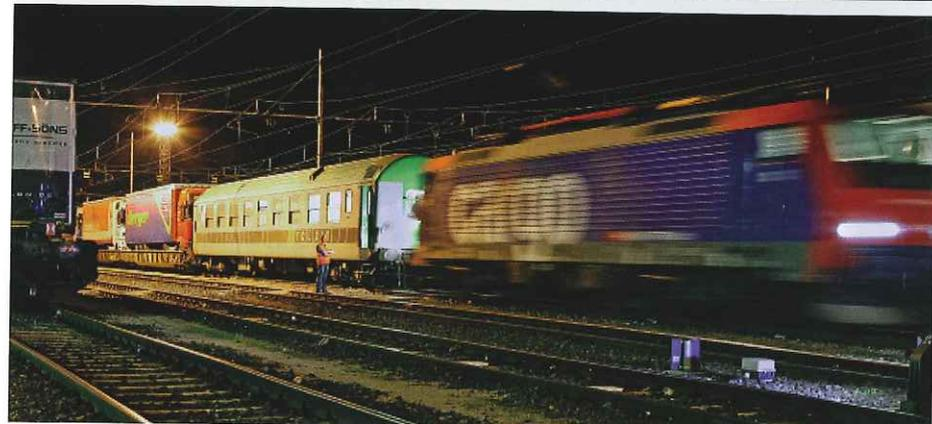
Hier übernimmt SBB Cargo Italia die Rola bis Novara. Gut zu sehen: Der Begleitwagen der Fahrer zwischen der Lok und dem ersten Tragwagen, auf dem Savics blauer Lkw schnell und sicher nach Süden reist.
